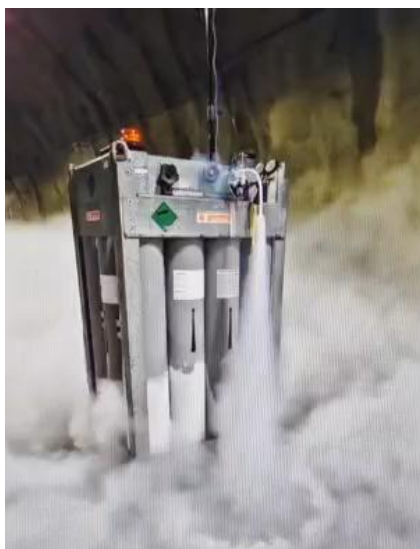
Kuva 23 Erilaisten kaasujen käyttäytymistä tunneleissa tutkitaan.
